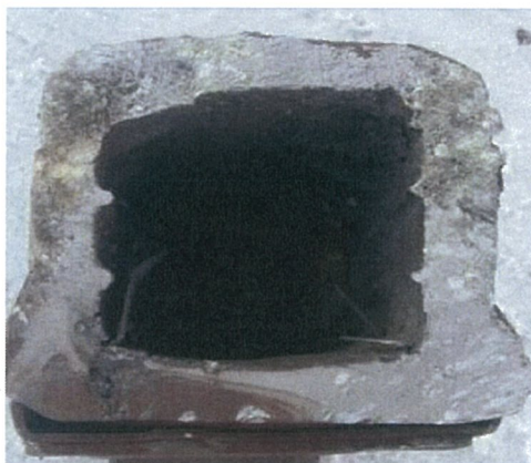
Рис. 2 – Злам бокової рами з внутрішнім ливарним дефектом
