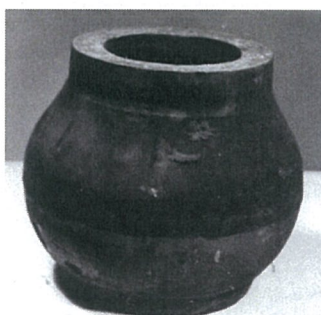
Рис. 2 – Відштампована сферична частина шарової опори. Товщина заготовки 16 мм, деталі 8 мм
