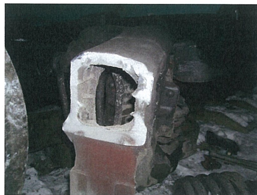
Рис. 3 – Вид руйнування бокової рами в експлуатації
